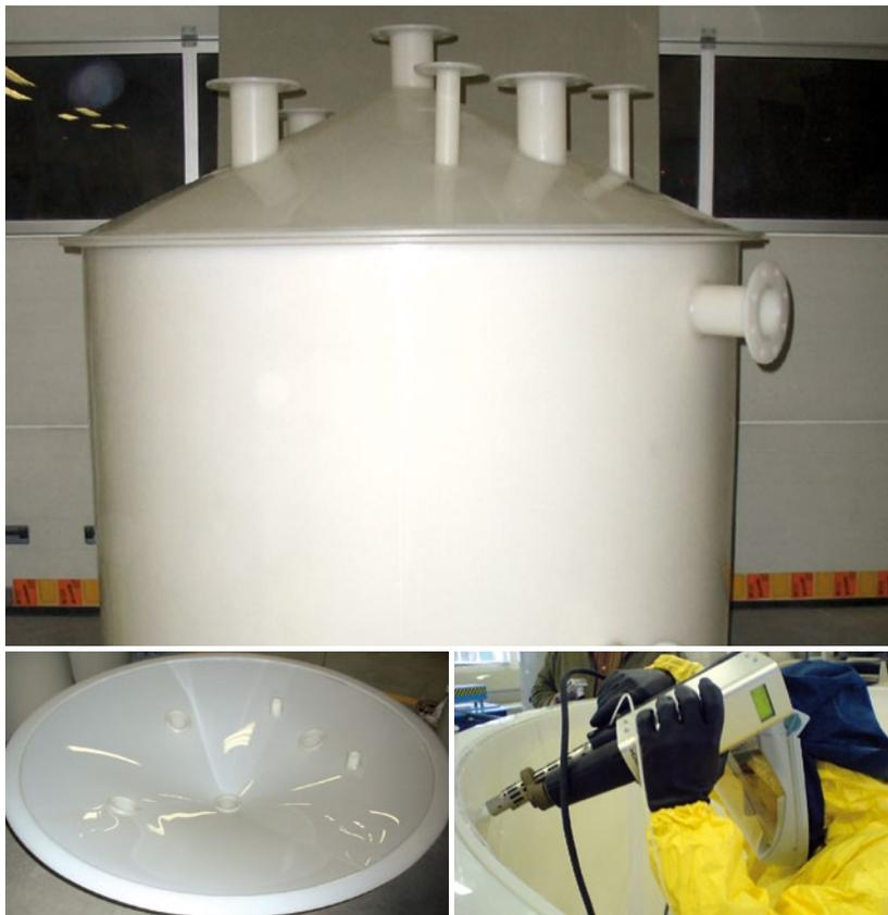
Oben: Fertiger Behälter. Unten: Dach des Behälters aus 8 mm dicken PVDF Platten. Verschweißen der PVDF Halbzeuge.
