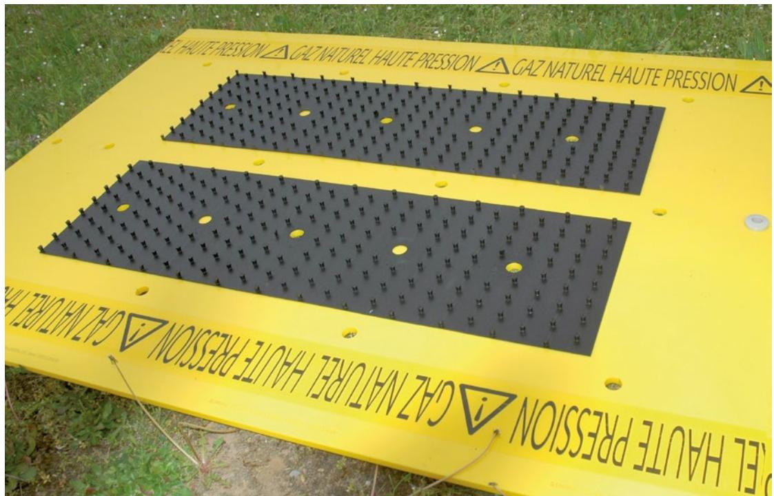
Die Löcher mit einem Durchmesser von 20 oder 30 Millimetern leiten Bodenfeuchte in das Erdreich ab. Sie minimieren Störungen der Stromlinien des kathodischen Korrosionsschutzes und wirken sich positiv auf die Plattenstabilität aus. Um die Stabilität zu gewährleisten, darf jedoch nicht mehr als 0,6 Prozent der Plattenfläche mit Löchern versehen werden.
