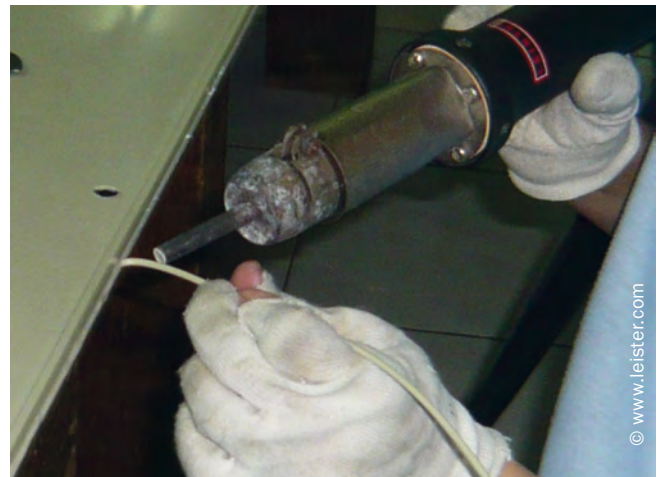
Abbildung 4: Warmgasfächelschweißen mit Rundscheidraht
