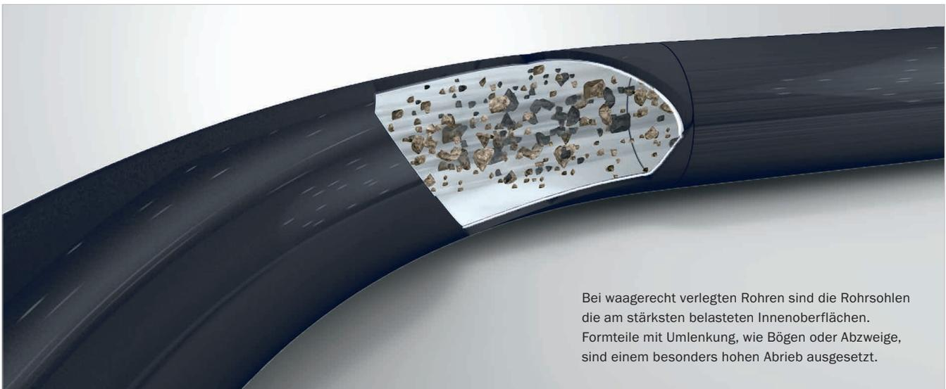
Bei waagrecht verlegten Rohren sind die Rohrsohlen die am stärksten belasteten Innenoberflächen. Formteile mit Umlenkung, wie Bögen oder Abzweige, sind einem besonders hohen Abrieb ausgesetzt.
