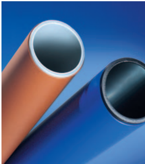
PE 80 SPC-Abwasserrohr: hellgraues PE Kernrohr, brauner PP Schutzmantel; PE 100 SPC-Trinkwasserdruckrohr: schwarzes PE Kernrohr, blauer PP Schutzmantel
