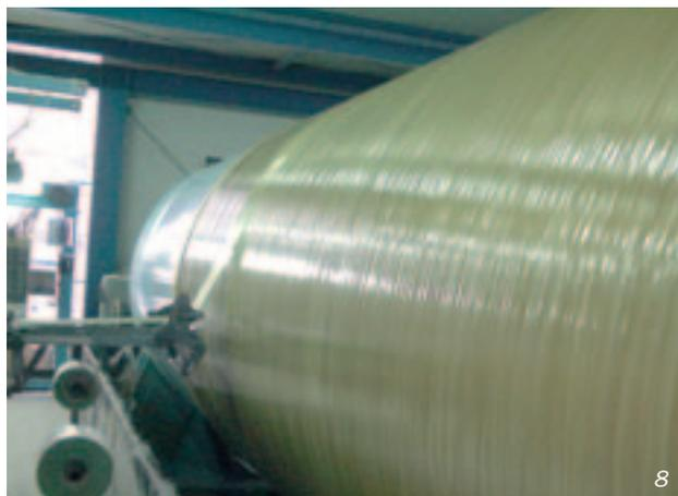
Auf alle Schweißnähte wird ein elektrisch leitfähiges Carbonband in der Schweißnahtbreite aufgeklebt. Dieses Carbonband dient zur Überprüfung der Dichtheit der Schweißnähte von der Behälterinnenseite mit einem Hochspannungsfunkenprüfgerät.
