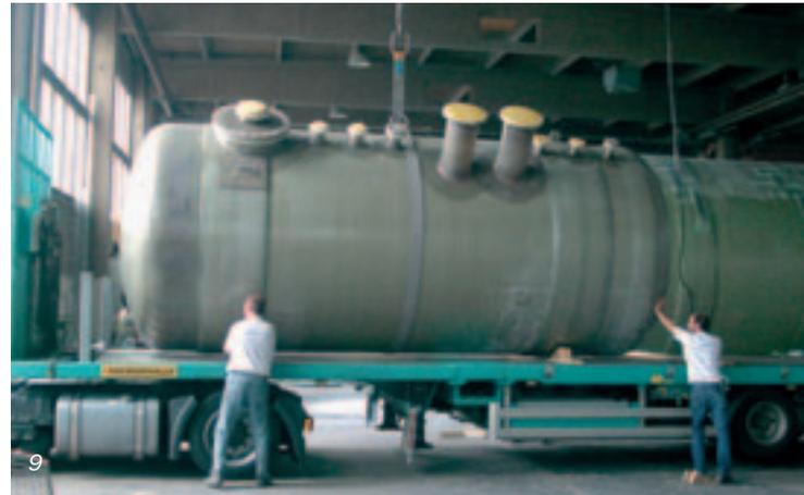
9 GFK-Verbundbehälter fertig zum Transport
