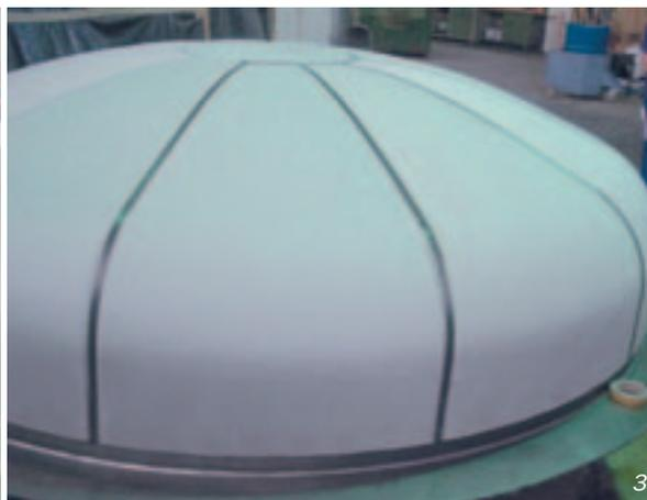
GFK ist ein Verbundwerkstoff aus Harz und Glas. Es werden sowohl ungesättigte Polyesterharze als auch Vinylesterharze als flüssige Reaktionsharze eingesetzt. Das als Verstärkungsmaterial eingesetzte Glas wird in Form von Roving, Matten und Gewebe verarbeitet. Die Verbindung von Harz und Glas zu einer tragenden Struktur wird als Laminat bezeichnet.
